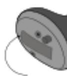
3. Setzen Sie die neue Batterie in das Batteriefach ein. Achten Sie darauf, dass das „+“ Zeichen auf der Batterie und das „+“-Zeichen in der Batterielade in eine Richtung zeigen.
